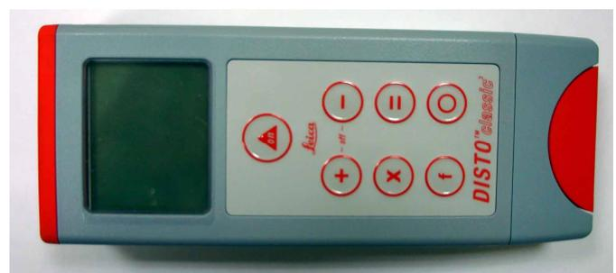
Distómetro que permite medir distancias de hasta 100 metros mediante un rayo laser.
