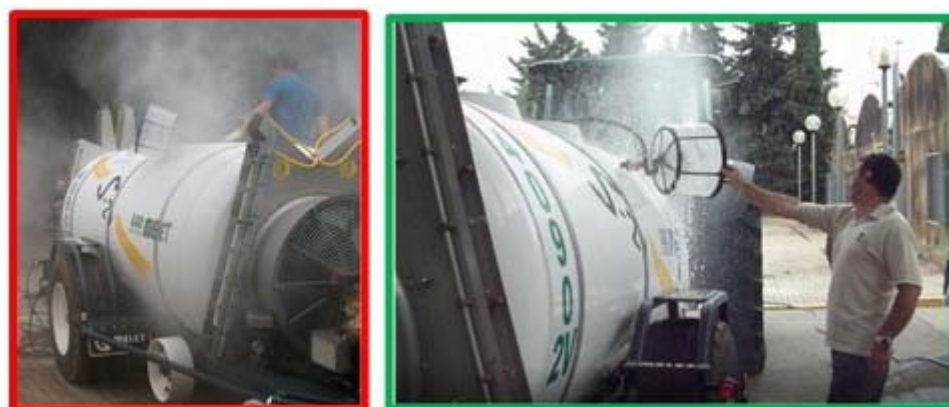
Figura 3: No es necesario estar expuesto a las vibraciones y el ruido que producen los EAPF durante su funcionamiento, pudiéndose realizar las tareas de inspección a cierta distancia.
