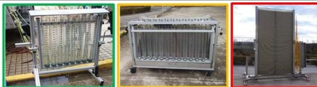
Figura 1: Diferentes tipos de caudalímetros mecánicos de probetas. Todos ellos tienen la misma finalidad en cuanto a la labor de inspección, pero desde un punto de vista ergonómico pueden presentar dificultades de manejo por su volumen y peso
